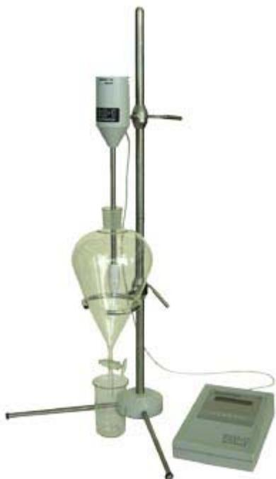
**Экстрактор лабораторный ЭЛ-1** предназначен для экстракционного концентрирования нефтепродуктов, ПАУ, фенолов, хлорорганических соединений, тяжелых металлов и других загрязняющих веществ из проб воды любыми органическими растворителями в делительных воронках.
