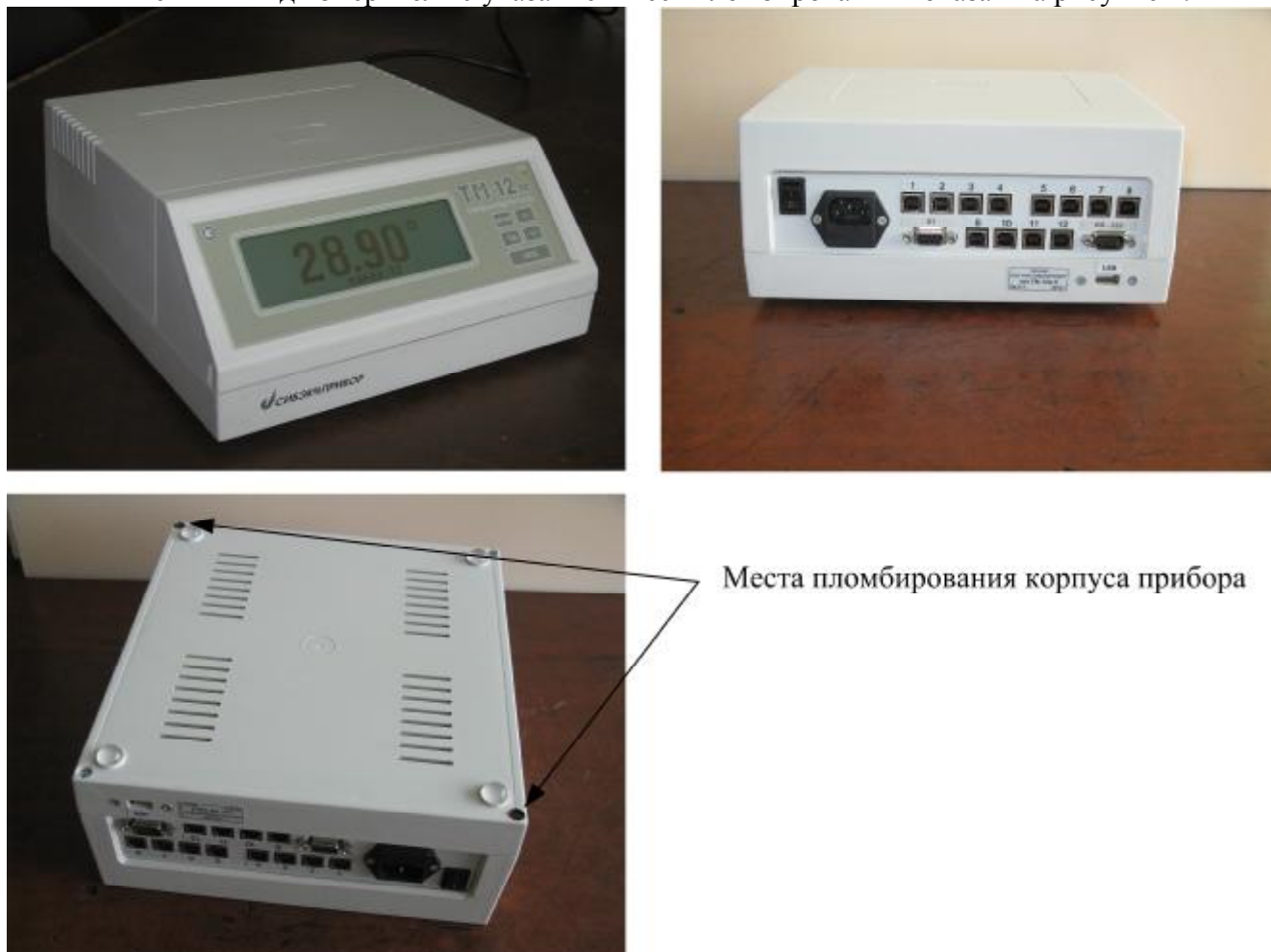
Рисунок 2. Внешний вид измерителя и места пломбирования корпуса
